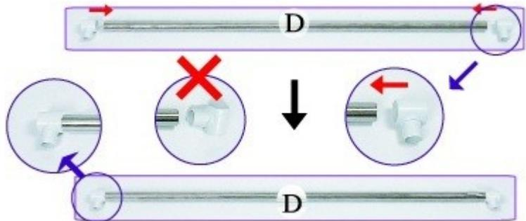
**Paso 6: Instalación de 2 ailes laterales (AP) repliables**
