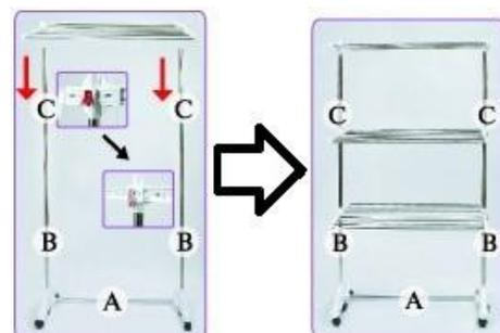
**Pas 5: Raccord pour barre D** Cherchez la barre D et mettez les 2 raccords dans la barre. Ensuite, vous pouvez mettre et fixer la barre D sur les barres C. Assurez que toute la construction se caractérise par une certaine stabilité.
